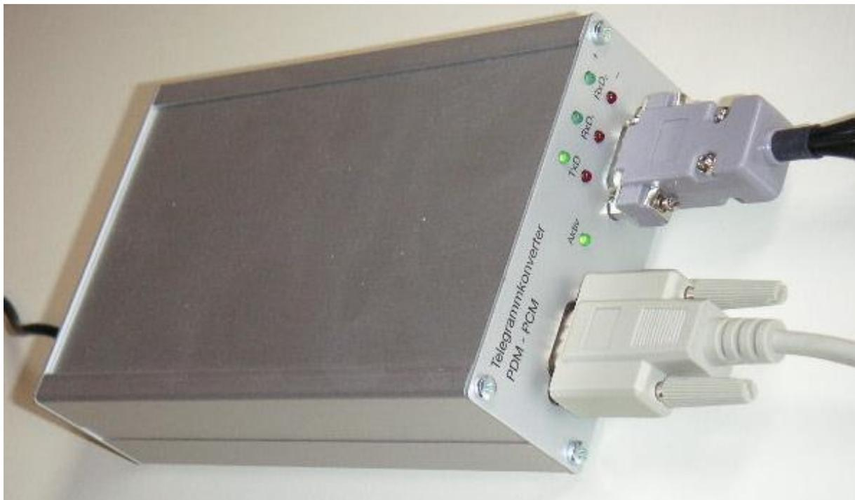
Abb. 3 Telegrammkonverter
